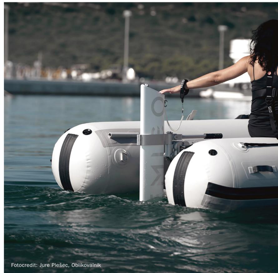
**Als weltweit erster vollständig integrierter 1000W Elektro-Außenbordmotor wurde der RemigoOne so konzipiert, dass er sowohl als Motor als auch als Ruder fungiert. Diese innovative Doppelfunktion stellt einen bedeutenden Fortschritt in der Nautik dar: die Funktionalität und Effizienz werden verbessert und gleichzeitig der ökologische Fußabdruck minimiert.**
